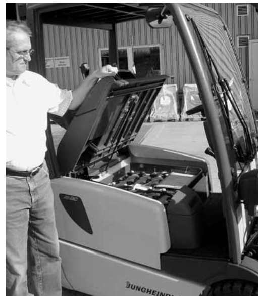
Bild 5: Anheben des Trogdeckels fürs Laden. So kann explosionsfähiges Gasgemisch entweichen.
